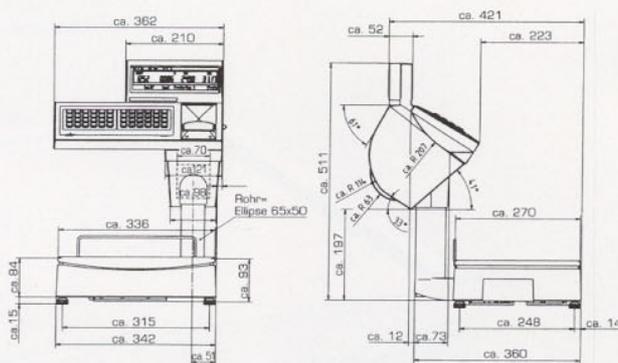
**\*\*BC 800 E - BILANCIA ELETTRONICA CON STAMPANTE DI ETICHETTE. FUNZIONAMENTO A BATTERIA, SENZA ALIMENTAZIONE DALLA RETE.**
